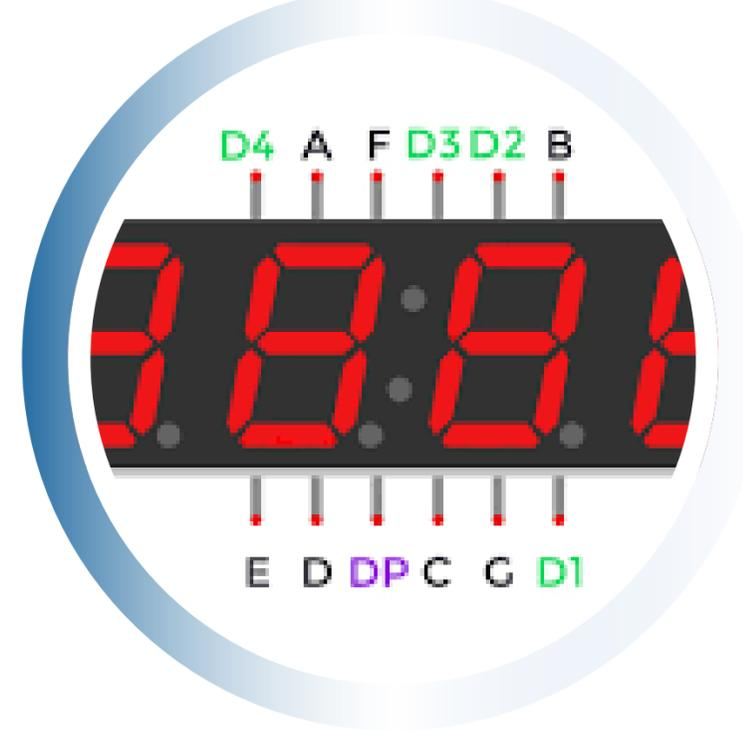
Module d'affichage composé de quatre chiffres 7-segments multiplexés.
